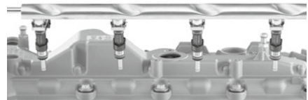
die Benzindirekteinspritzung Ben-zin-di-rekt-ein-sprit-zung <-en> Kraftstoff wird von einer Einspritzdüse direkt in den Brennraum gespritzt ▶ 03.006
