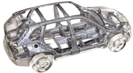
der Fahrzeugaufbau Fahrzeugaufbau <-ten> Äußeres des Autos; alle Teile, die zum Kfz gehören, z. B. Rahmen, Türen und Klappen 🔴 01.004
